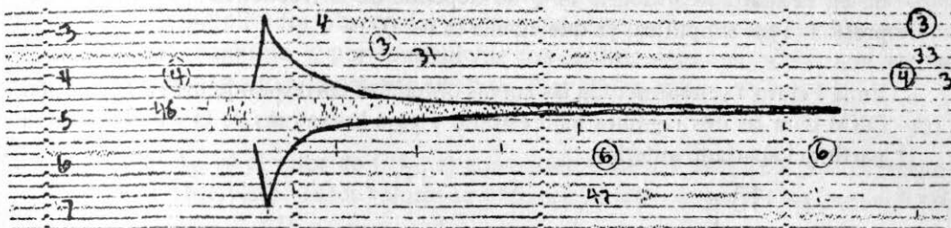
Fig. 2. Ejemplo de sismograma utilizado en donde se muestra la coda utilizada (línea gruesa). Temblor del 1o. de marzo de 1979; Hora origen: 04 h 45 m 22.5 s . Estación: OXM.
