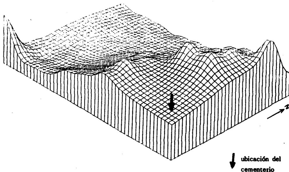
Fig. 3. Modelo isométrico tridimensional de la conductividad del terreno.
