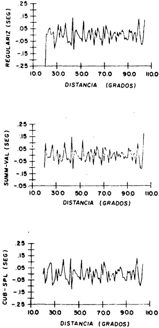
Fig. 1. Residuales como función de la distancia epicentral que resultan de la aplicación de un método de polinomios osculantes ("splines") cúbicos con nodos variables, del de valores sumarios y del de regularización.
