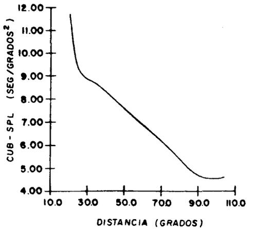
Fig. 2. Primera derivada de la función incógnita como función de la distancia epicentral. Se presentan los resultados de derivar las funciones suavizadas por los tres métodos señalados en la figura 1.
