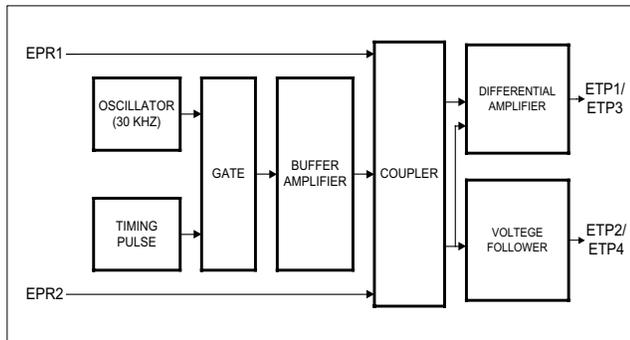
Fig. 7. ETP MODULE-B Block Diagram.
